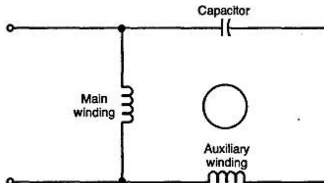
Figure 3: PSC motor wiring<sup>1</sup>
